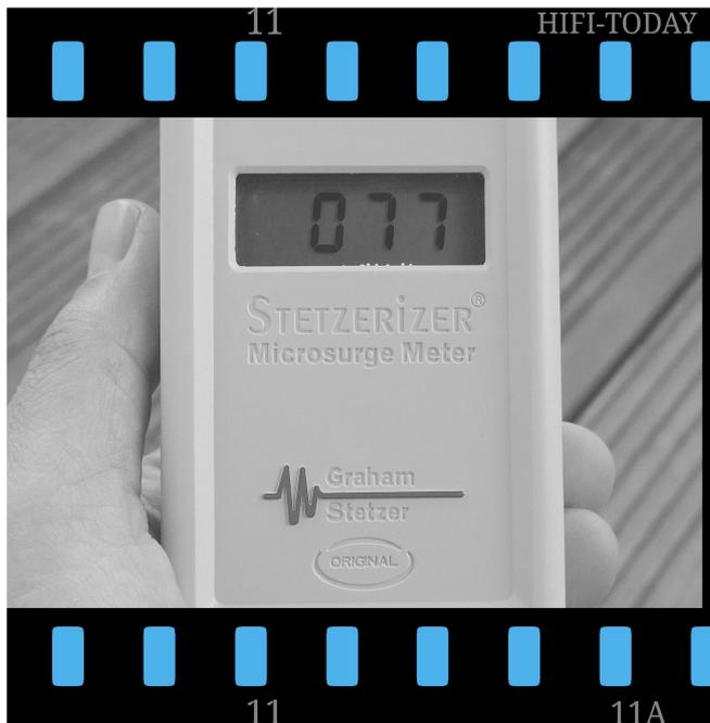
sogenannte Microsurge Meter den Störungsanteil der Netzspannung digital an. Die Anzeige erfolgt in GS-Einheiten, die nach den Initialen der Erfinder, Professor Dr. Martin Graham (emeritierter Professor der University of California at Berkeley) und der Elektronikspezialist **David Stetzer** benannt wurden.
